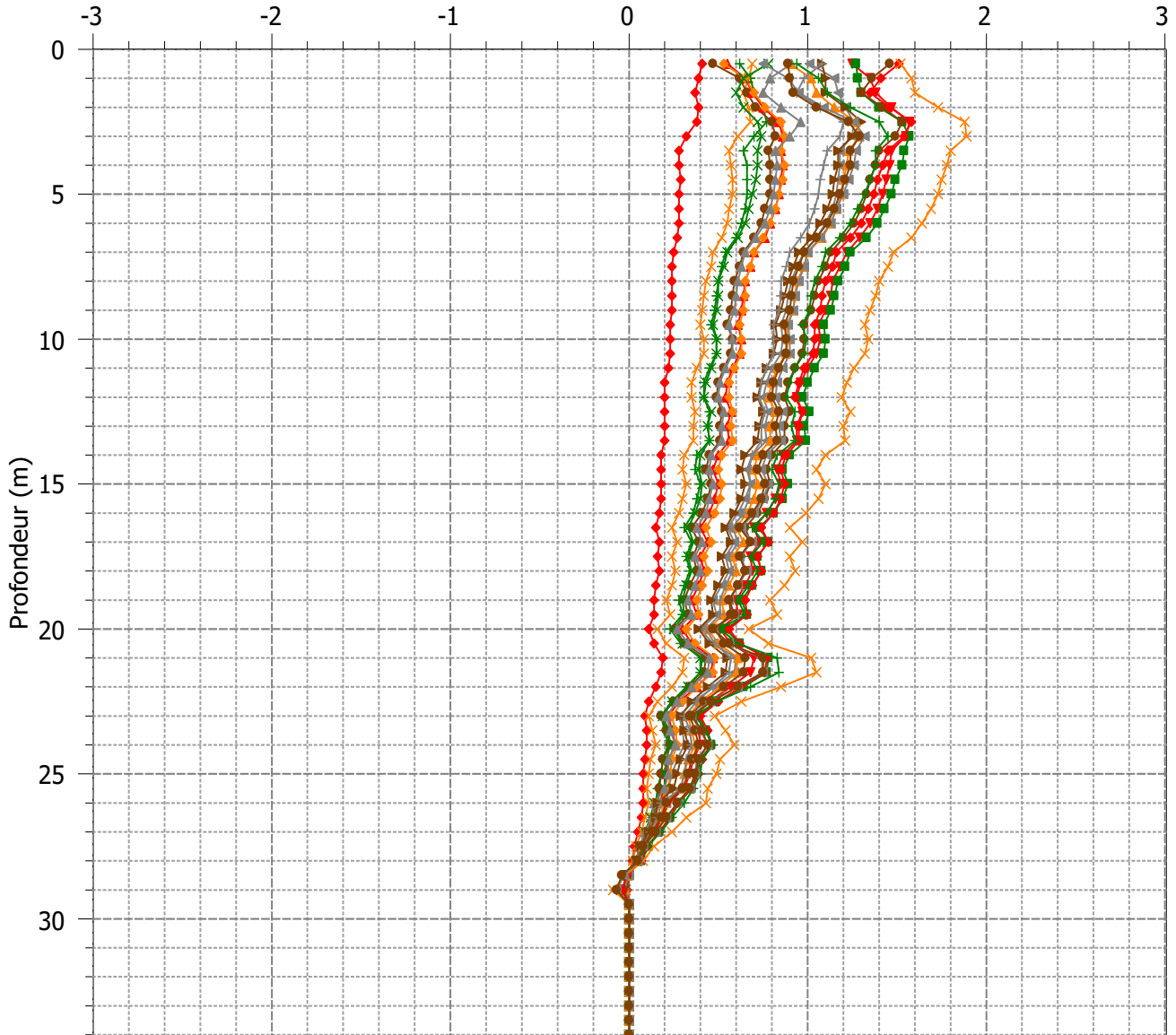
Evolution des déplacements relatifs cumulés (cm) - A1A2 (les déplacements positifs correspondent à un déplacement de A2 vers A1)
